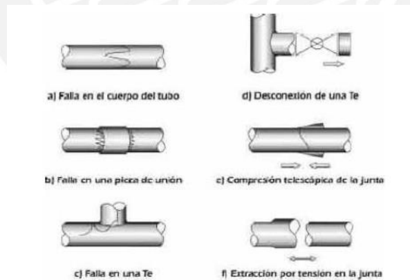
Figura 6: Fallas más comunes en tuberías de PVC. Fuente: Diez & Muñoz, 2019.
