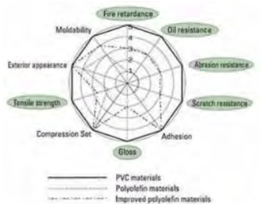
Figura 5: Eficiencia en las propiedades físicas del PVC, al mezclarse con aditivos. Fuente: Makino, 1998
