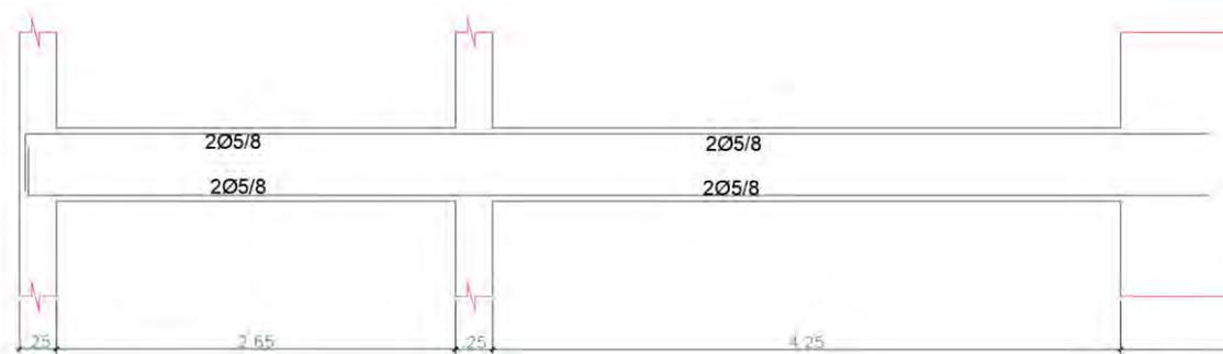
Figura 34: Vista de elevación de los aceros colocados en la viga V-01A
