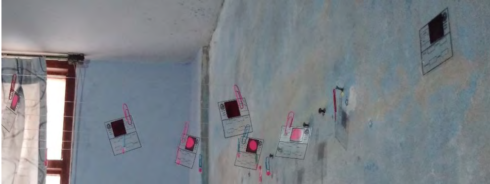
Figura 4.9: Primer grupo formado por detectores LR115 en la segunda habitación (Vista lateral).
