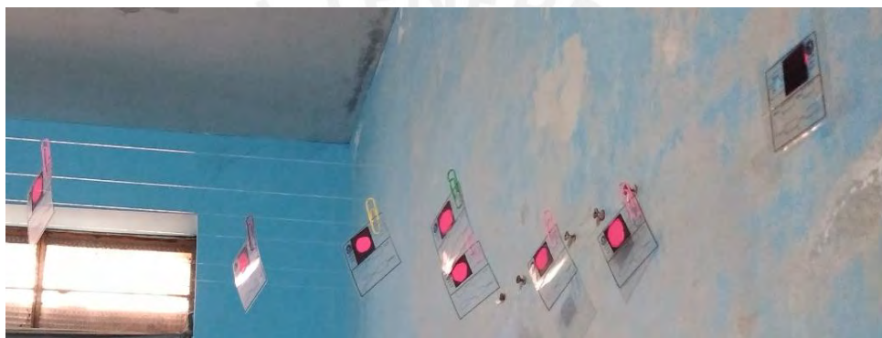
Figura 4.7: Segundo grupo formado por detectores LR115 en la primera habitación (Vista lateral).
