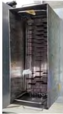
Figura 4.14: Proceso de grabado de detectores LR115 en sistema cerrado de grabado.
