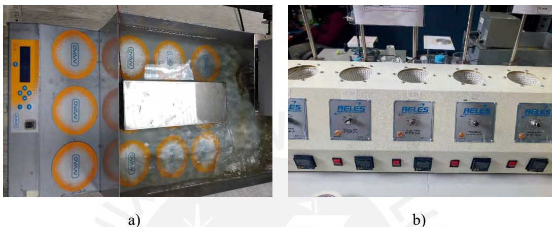
Figura 4.13: Sistema de grabado de detectores: a) tipo abierto y b) tipo cerrado.
