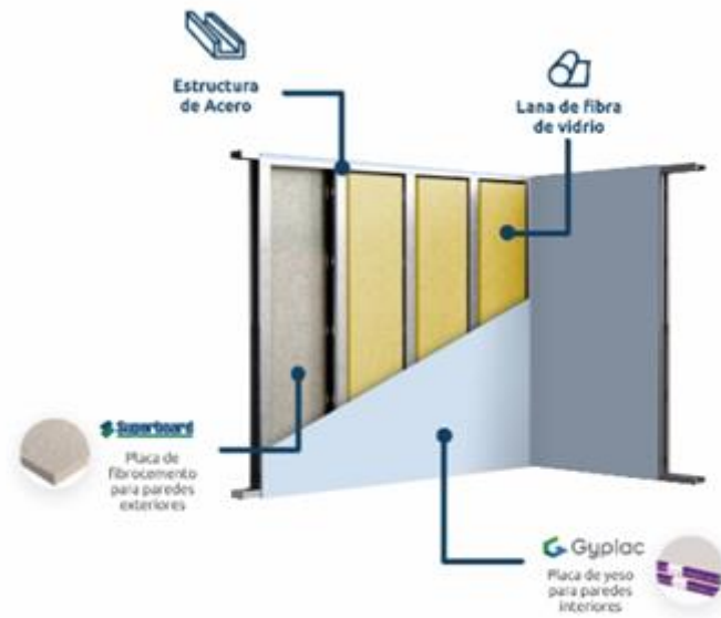
Figura 7: Sistema de muros Drywall.
