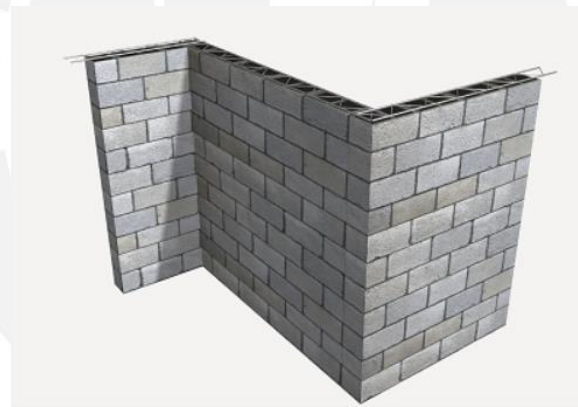
Figura 5: Muro de albañilería armada.
