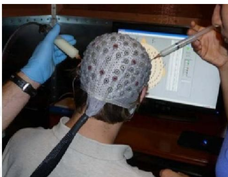
Figura 2- 17. EEG alámbrico basado en electrodos húmedos. Fuente: Extraído de (Nathan, 2013).
