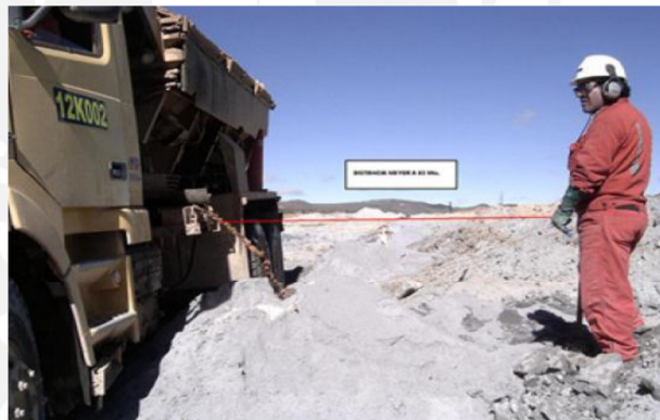
Figura 12: Colocación de taco en taladro..
