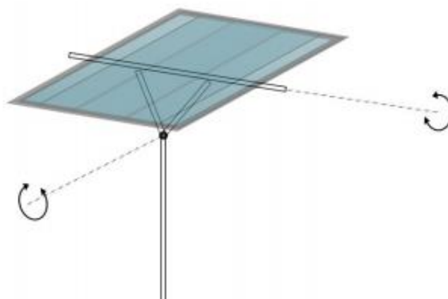
Figura 1. 15 Seguidor solar con doble eje de inclinación [Sanchez, 2010].
