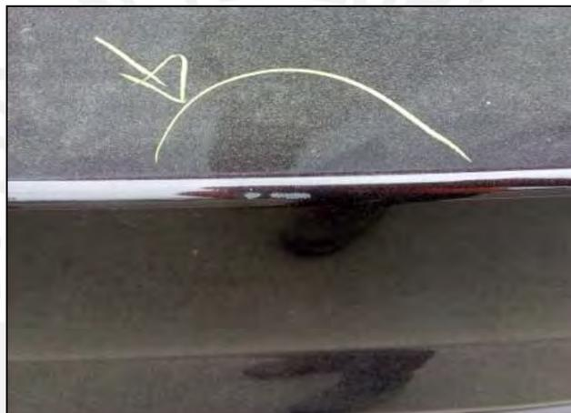
Figura 3.23: Rayadura en parachoques trasero
