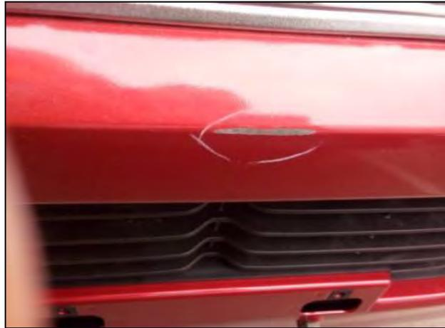
Figura 3.22: Rayadura en parachoques frontal
