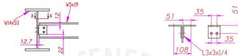
Figura 4.26 Conexión de evaporador-Propuesta N°1
