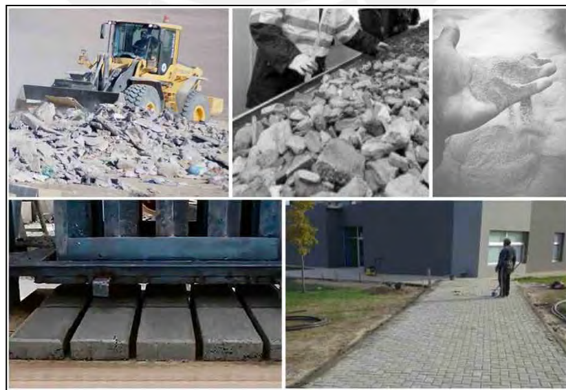
Gráfico 52 – ciclo de fabricación de adoquines y ladrillos reciclados Fuente: https://ciclo.com.pe
