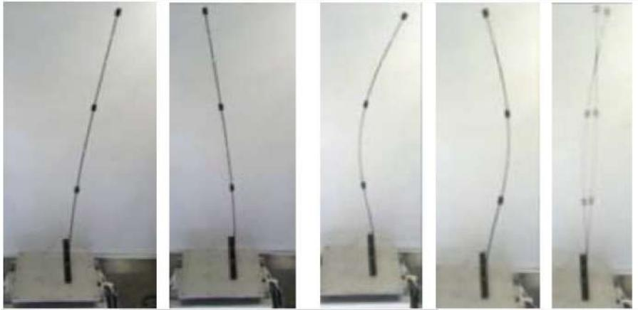
Figura 34. Resonancia de péndulos con diferentes periodos de vibración.
