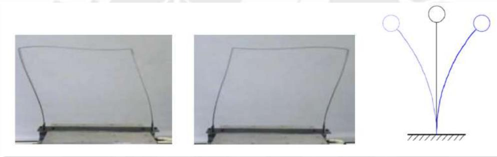
Figura 32. Vibración de un pórtico de un piso o péndulo simple.
