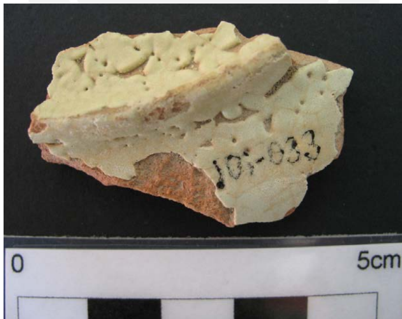
Foto 10. "Arrugamiento" como consecuencia de una mala cocción
