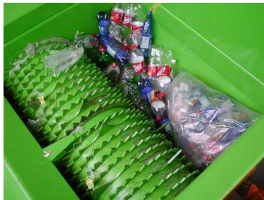
Figura 1.05. Compactadora de un rodillo
