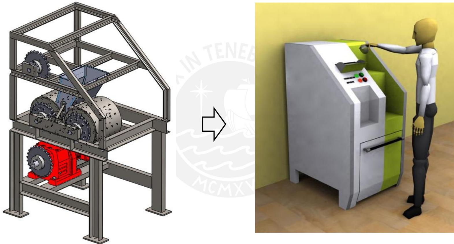
Figura 2.06. Diseño de la compactadora (izquierda) y esquema de máquina completa (derecha)
