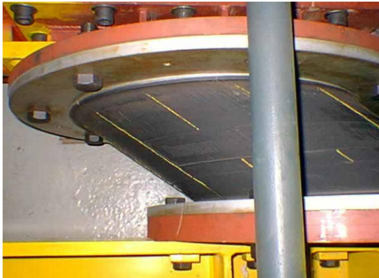
Fotografía 2. Aislador sometido a ensayos en la Universidad Católica de Chile.
