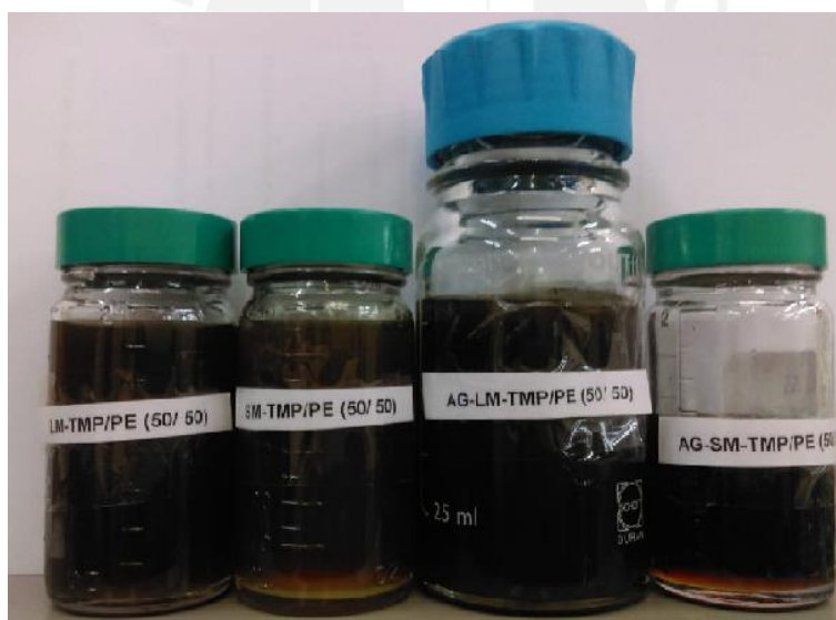
Figura 16. Resinas sintetizadas a partir de aceite de sachá inchi, linaza y sus respectivos ácidos grasos con TMP/PE (50/50). De izquierda a derecha: LM, SM, AG-LM y AG-SM
