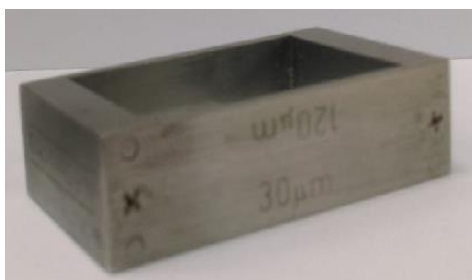
Figura 21. Aplicador de resina Erichsen de 38mm de ancho.
