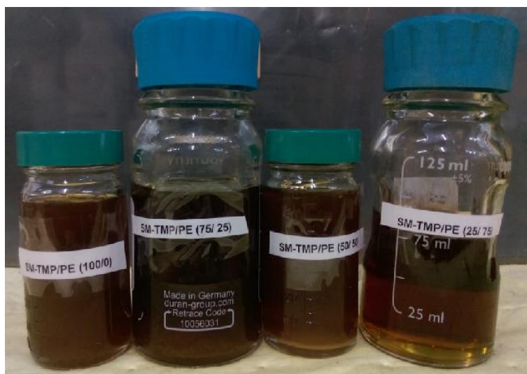
Figura 15. Resinas sintetizadas a partir de aceite de sachá inchi con diferentes proporciones TMP/PE. De izquierda a derecha: SM (100/0), SM(75/25), SM(50/50) y SM (25/75)
