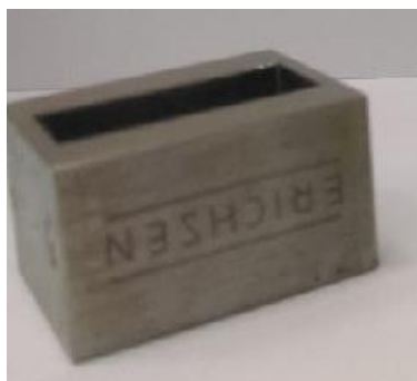
Figura 18. Aplicador de resina Erichsen para película de 12 mm de ancho.
