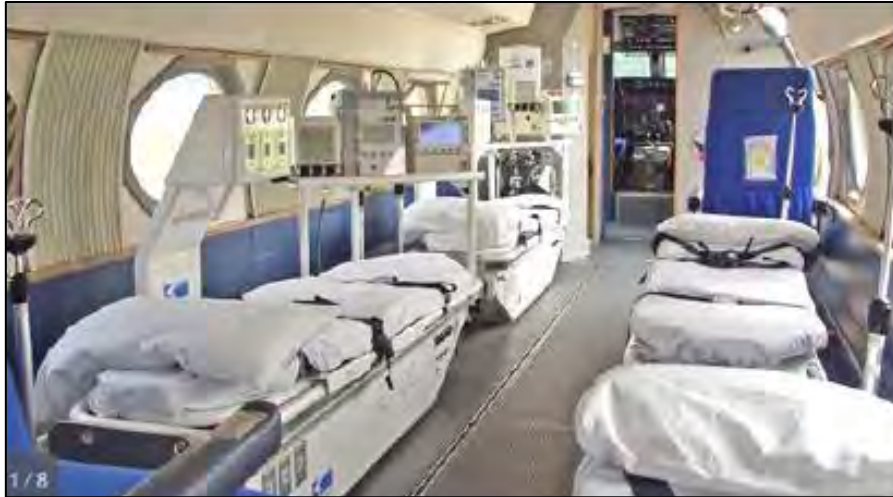
Figura 15. Kit de ambulancia aérea típico de un avión Twin Otter Fuente: Viking, junio 2019.
