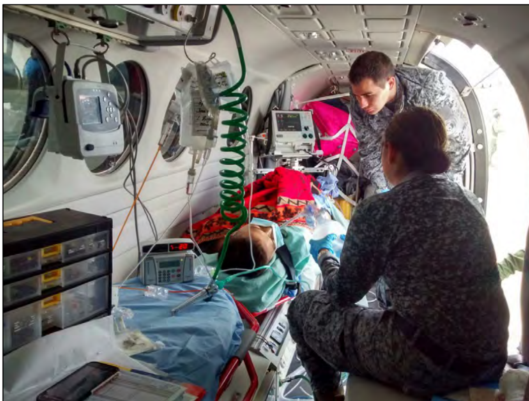
Figura 42. Interior de la cabina con kit de ambulancia de un King Air 350 Fuente: FAC, agosto 2019.
