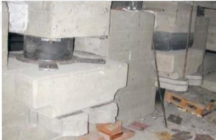
**Figura 1.1:** Abultamiento en aislador con lámina de acero (izq.) y sin láminas de acero (der.) (Gjorgjiev & Garevski, 2012)
