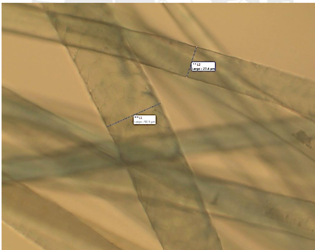
Figura 74. Microfotografía de fibra de trama de color verde (teñido) del tapiz del MCP. Medidas del diámetro: L1 59.9 \mu m, L2 27.4 \mu m
