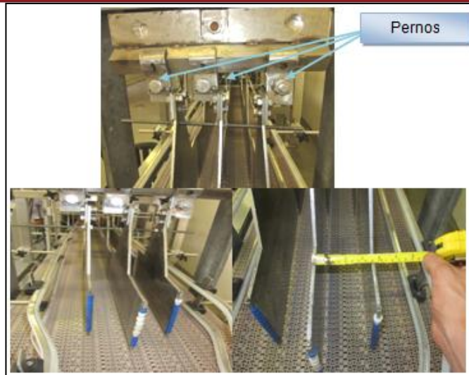
Figura 42: Planchas separadoras a la entrada de la empacadora Fuente: La Empresa
