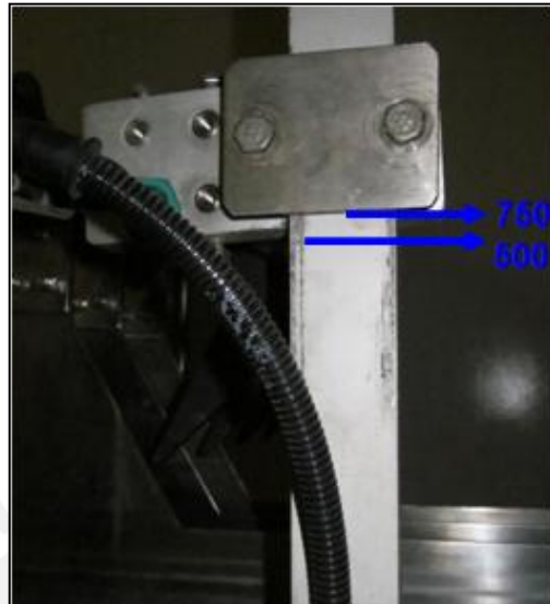
Figura 55: Marcas en el sensor de la empacadora
