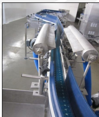
Figura 40: Cuchillas de aire a la salida del túnel de vapor
