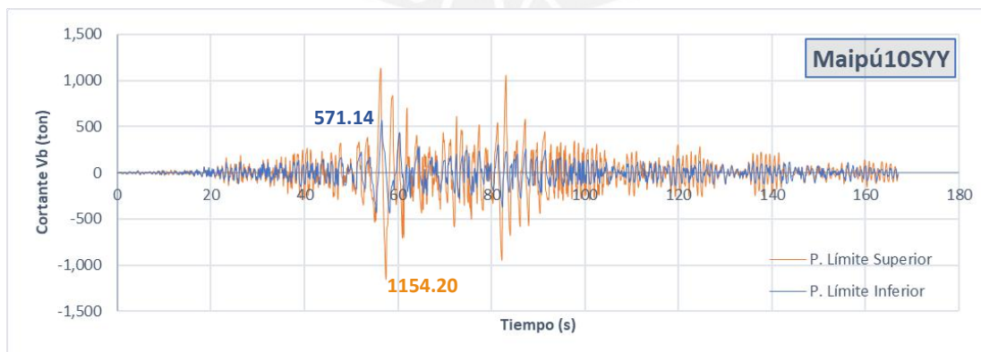
Figura A5.4. Historia de fuerza cortante en la base aislada en Y-Y considerando las propiedades del límite superior e inferior (continuación).
