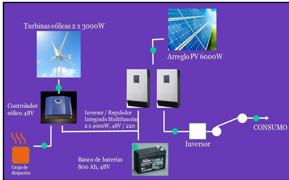
Figura 9. Esquema de micro-red híbrida en Laguna grande
