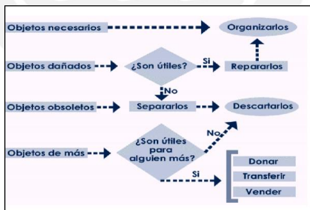
Figura 10. Diagrama de Flujo para Clasificación - Seiri. Tomado de Manual de Implementación del Programa 5s - Vargas - Consultado: Oct 2018
