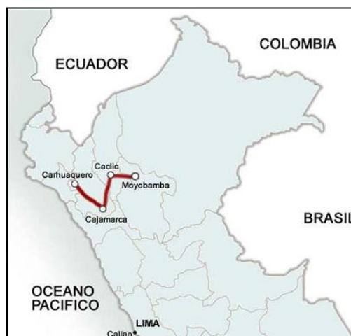
FIGURA 3- 1 RECORRIDO GENERAL DE LA RED DE TRANSMISIÓN ELÉCTRICA DE 220 KV CARHUAQUERO – CAJAMARCA NORTE – CÁCLIC – MOYOBAMBA [INV2012]
