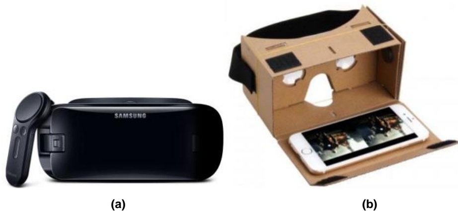
Figura 2. 18 Los cascos para usar celulares como gafas de realidad virtual: (a) Gear VR (Samsung Electronics, Seúl, Corea del Sur) y (b) Google cardboard (Google LLC, California, Estados Unidos).
