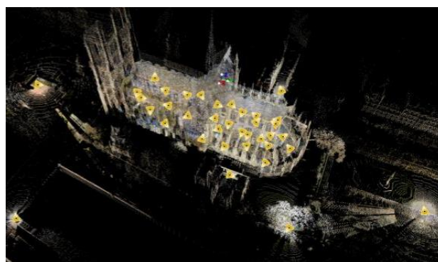
Figura 2. 5 Modelo en nube de puntos de la catedral de Notre Dame (París, Francia) [49].
