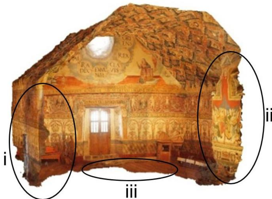
Figura 3.6 Se muestra el coro con las deficiencias propias de los modelos provenientes de la fotogrametría. Primero, i) en esta parte se localiza un órgano del coro que apareció unida a la estructura total. Al ser removida para presentarse como objeto único destruyó esa parte de la estructura. Segundo, ii) se observa uno de los órganos del coro parcialmente destruido debido a la dificultad para tomar las fotografías de esa parte. Tercero, iii) se observa esta parte de la estructura totalmente destruida, pero en realidad en este lugar se localiza la baranda del coro.
