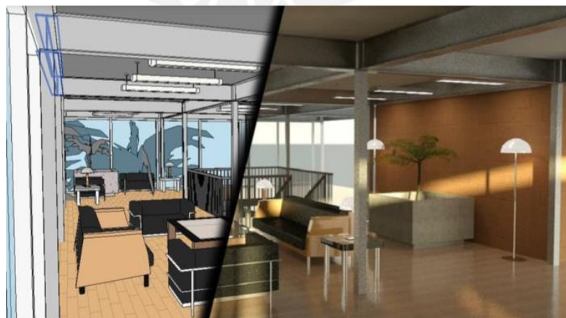
Figura 2. 13 Ejemplo de un modelo tridimensional sin renderizado (izquierda) y con renderizado (derecha). [55]
