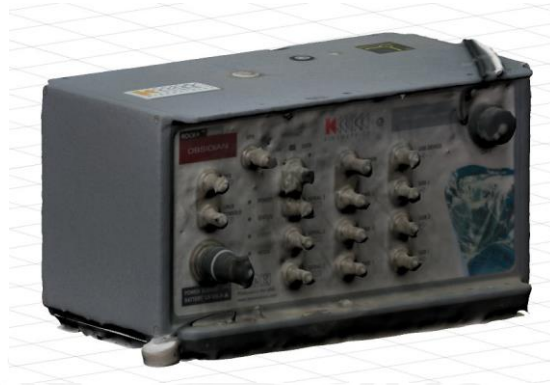
Figura 4. 17 Modelo tridimensional del equipo de adquisición de data sísmica Obsidian de la marca Kinemetrics.
