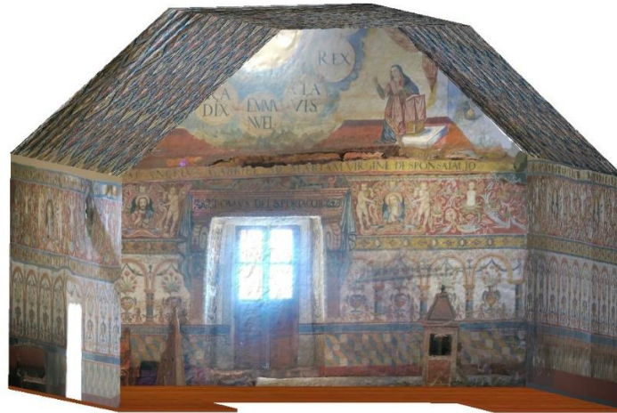
Figura 4. 5 El modelo tridimensional del coro ya no presenta huecos en la estructura, no tiene unidos los objetos tridimensionales aledaños y además su base es un modelo tridimensional simple sin reducir la calidad del modelo.
