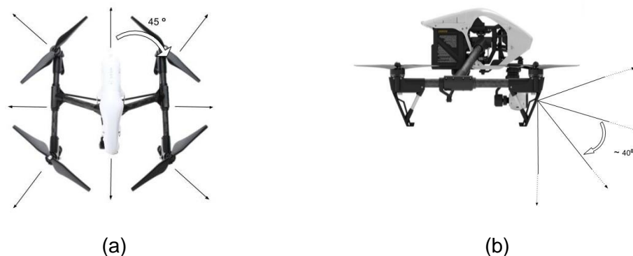
Figura 3. 5 (a) el dron se gira cada 45 grados en su eje z y en cada rotación (b) se toma fotografías rotando la cámara cada 40 grados en su eje x.
