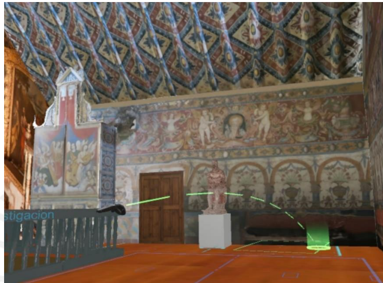
Figura 4. 13 El traslado en la escena se logra presionando el touchpad del control del HTC VIVE y dirigiendo el arco brillante hacia el punto al que se desea trasladarse.
