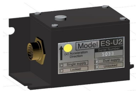
Figura 4. 20 Modelo tridimensional del sensor que se utiliza en el proyecto “Monitoreo de salud estructural”.
