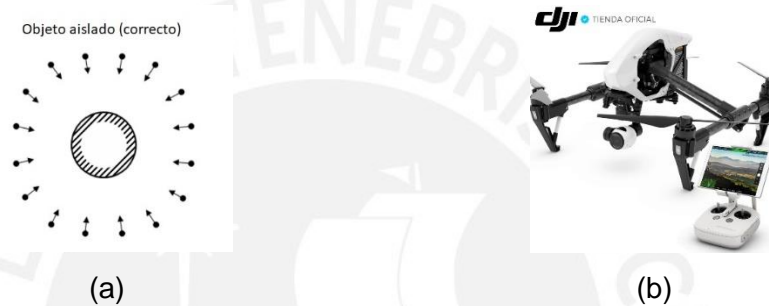
Figura 3. 3 (a) Patrón a seguir para toma fotográfica de un objeto aislado como es el caso de la parte externa de la iglesia (imagen modificada [50]). (b) Dron Inspire 1 que permite la toma fotográfica aérea de objetos de gran tamaño y viene equipado con la cámara fotográfica Zenmuse X5 de 16 megapíxeles.
