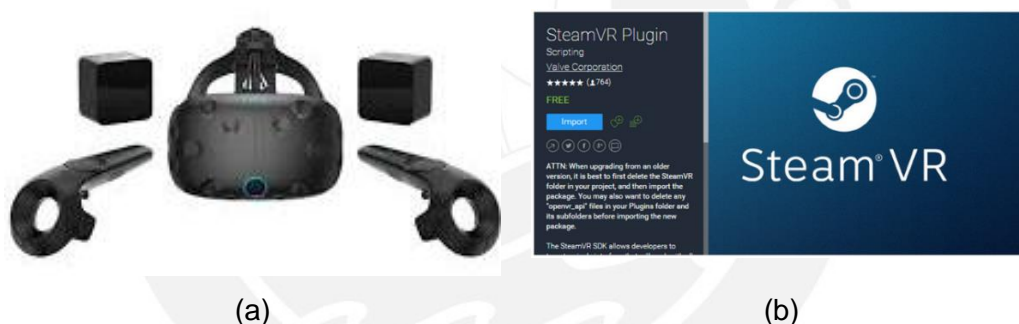
Figura 3. 9 (a) Equipo HTC VIVE de realidad virtual cuyos componentes son un casco con vista estereoscópica que permite visualizar la realidad virtual; dos controles integrados con un botón trigger, un touchpad y un botón auxiliar que permiten la interacción entre el usuario y el mundo virtual; posicionamiento en un área delimitada tanto de los controles como del casco con lo cual puedes moverte en el mundo real y sentirlo en el mundo virtual gracias a su posicionamiento basado en luz infrarroja. (b) El plugin Steam VR posee un conjunto de herramientas para facilitar la programación del HTC VIVE en el motor de videojuegos Unity 3D.
