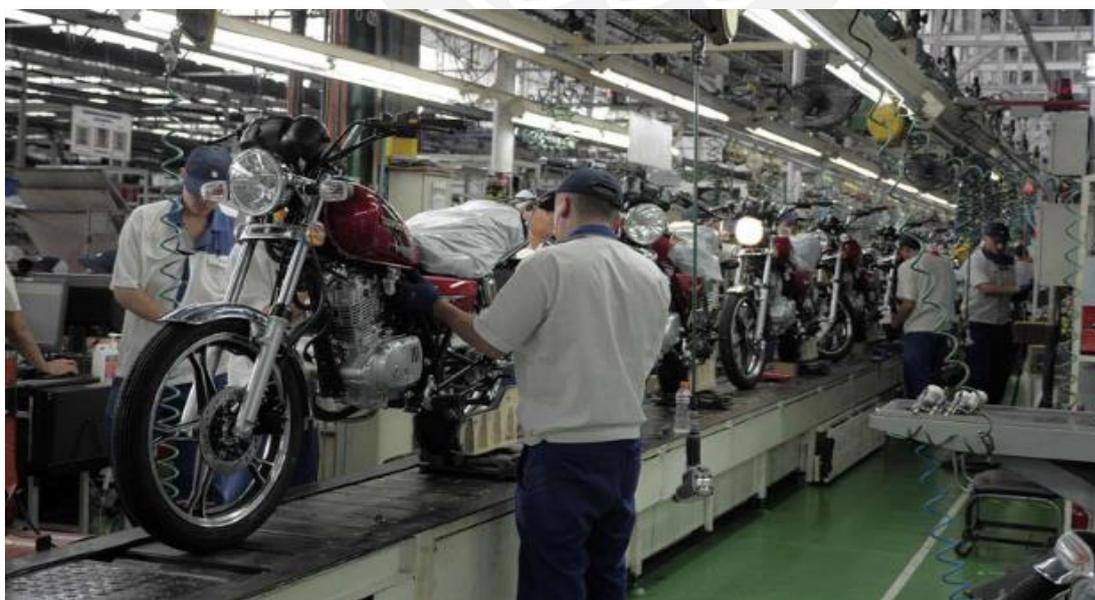
Figura 7 Línea de ensamble de motos
