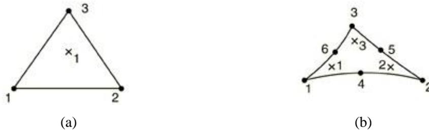
Figura 3.4: Elementos triangulares con integración reducida: (a) lineal; (b) cuadrático.
