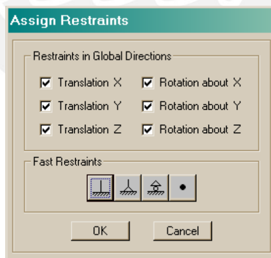
Figura 5-19.- Restricciones asignadas en la base.
