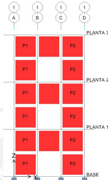
Figura 3-32.- Ejemplo de etiquetado de muros pier.
