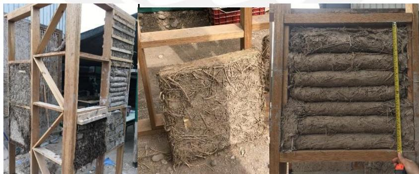
Figura 5.24: a) Relleno con bloque. b) Relleno con paneles. c) Relleno con rollos (fotos propias).
