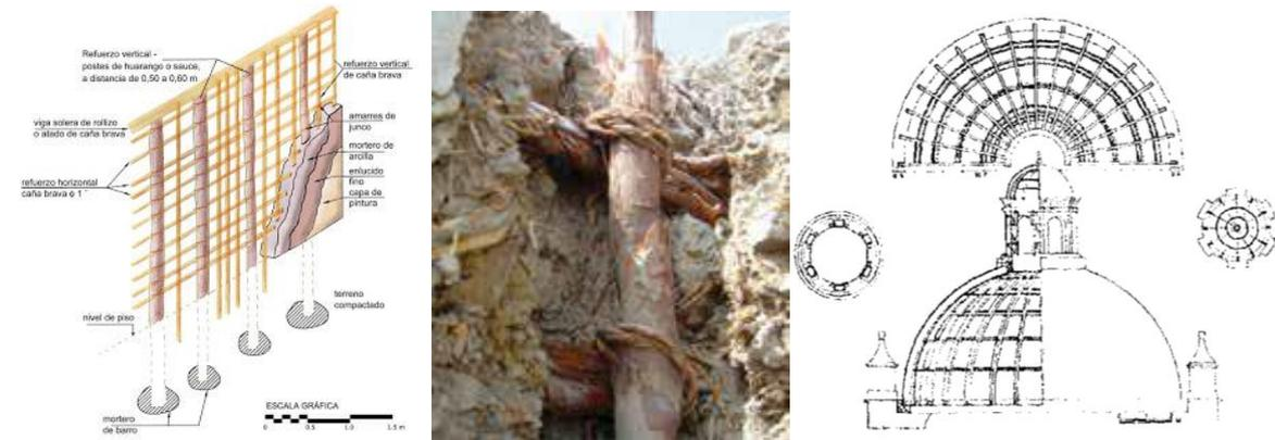
Figura 2.8: a) Descripción estructural de las estructuras de Quincha construidas en Caral. b) Muro en el cual se incluían refuerzos de caña y sogá (Fuente: Ministerio de cultura 2014). c) Cupulas de la Iglesia de San Francisco, construidas en 1645 (Fuente: Rodríguez 2003).
