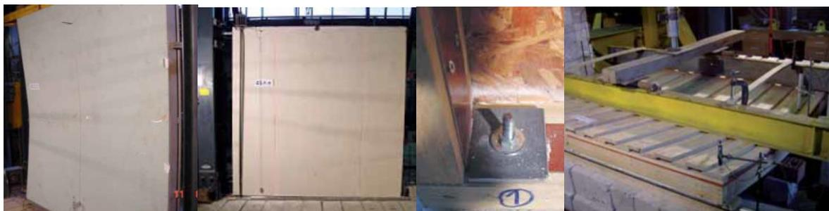
Figura 2.20: a) Ensayo a compresión. b) Ensayo de corte coplanar. c) Ensayo de corte-flexión. d) Ensayo de flexión transversal (Fuente: CIDM, 2011, pp. 161-171)
