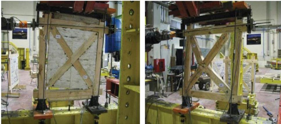
Figura 2.17: Ensayo de corte coplanar en paneles tipo "Gaiola" (Fuente: Lopes, 2010)
