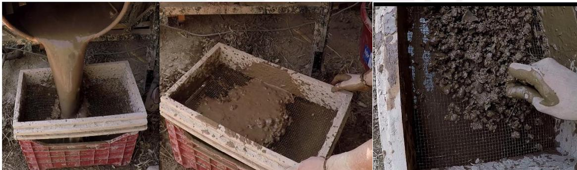
Figura 5.8: Procedimiento del tamizado de la mezcla líquida (Fotos propias)
