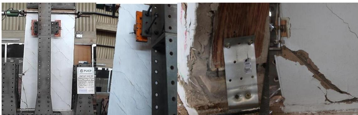
Figura 6.5: a) y b) Agrietamiento por corte. c) Falla de las pletinas. d) Falla del talón del muro
