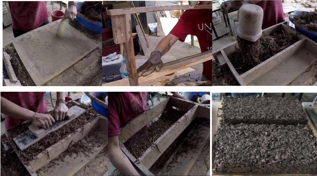
Figura 5.14: Encofrado y compactación de los bloques
