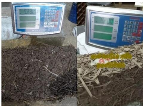
Figura 5.16: Peso de los bloques en la balanza en su estado húmedo (izquierda) y seco (derecha).
