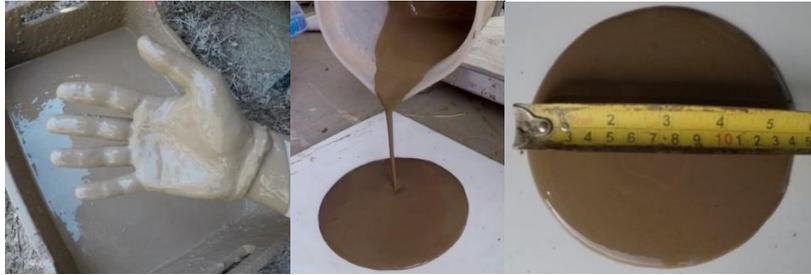
Figura 5.9: a) Prueba del recubrimiento. b) y c) Prueba del esparcimiento. (Fotos propias)
