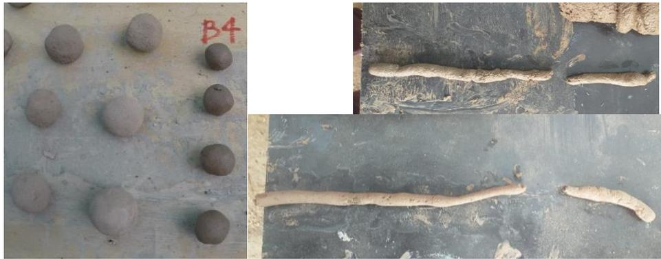
Figura 5.3: Pruebas de control: a) Prueba de la bolita, b) y c) prueba de la cinta de barro en T1 y T2 respectivamente
