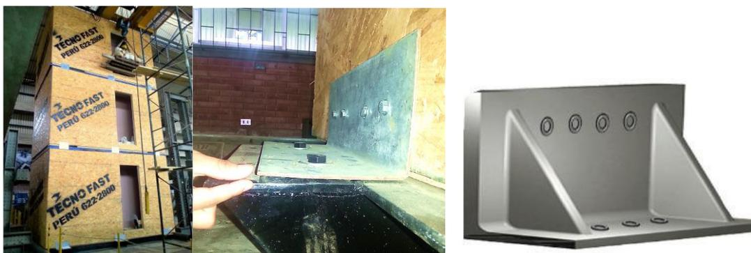
Figura 2.21: A la derecha la vivienda de madera ensayada, al medio la falla de las uniones metálicas y a la derecha la escuadra metálica reforzada propuesta por los autores (Fuente: Ordoñez y Lugo 2016, pp. 66)
