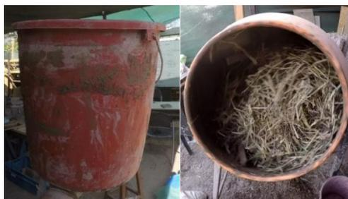
Figura 5.11: Unidad de medida utilizada y mezclado de la paja en el trompo (Fotos propias)
