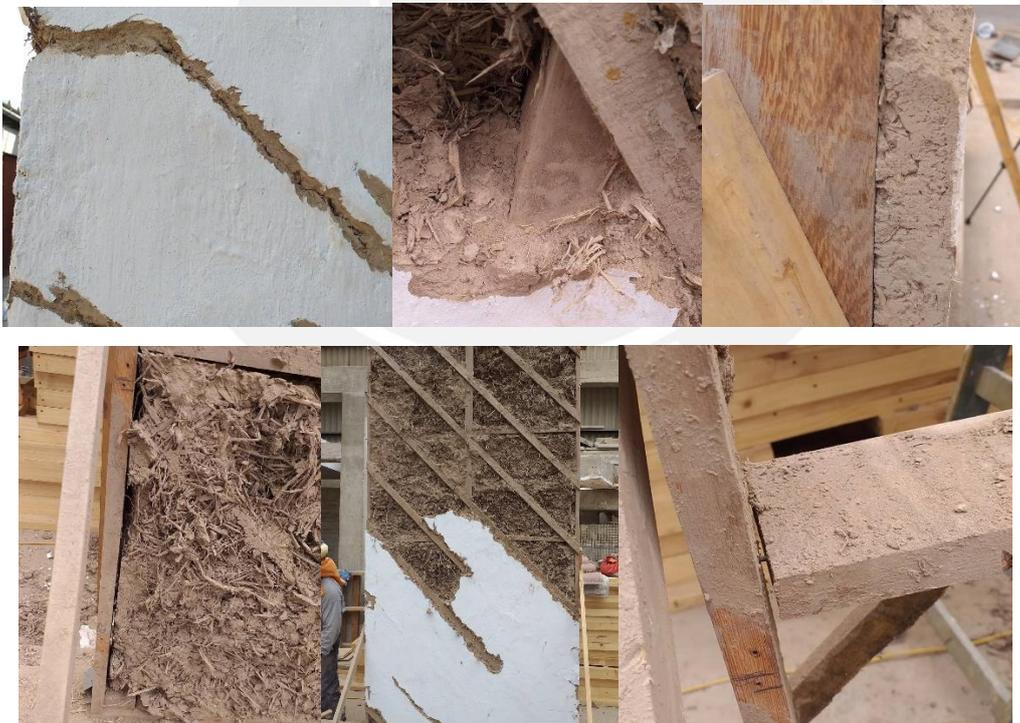
Figura 6.6: a) Verificación de la profundidad de las fisuras. b) y c) Buena adherencia entre el mortero y el revestimiento a la estructura de madera. d) Desprendimiento de los bloques. e) Estado final de los bloques, más dañados en la parte superior. f) Falla de extracción interna del travesaño al pie derecho (fotos propias)
