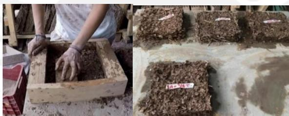
Figura 5.6: Cuatro pruebas de mezcla con variación en la relación tierra:agua (fotos propias)
