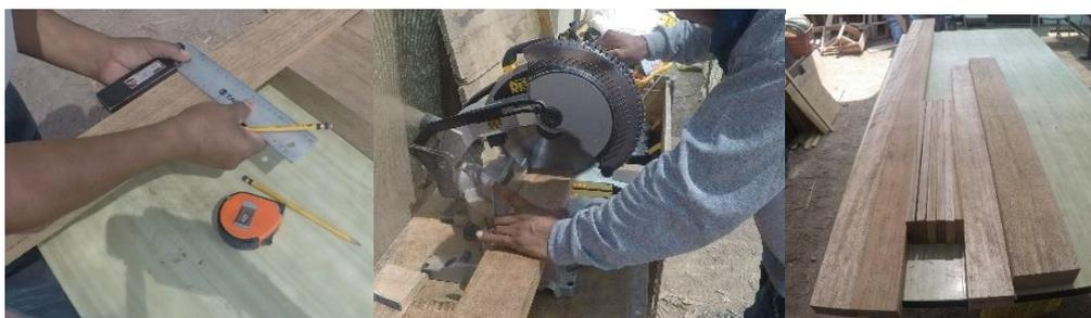
Figura 5.17: a) Selección y dimensionado de la pieza a cortar. b) Cortado de los elementos con la sierra circular mecánica. c) Todos los elementos cortados que conforman el panel (fotos propias)
