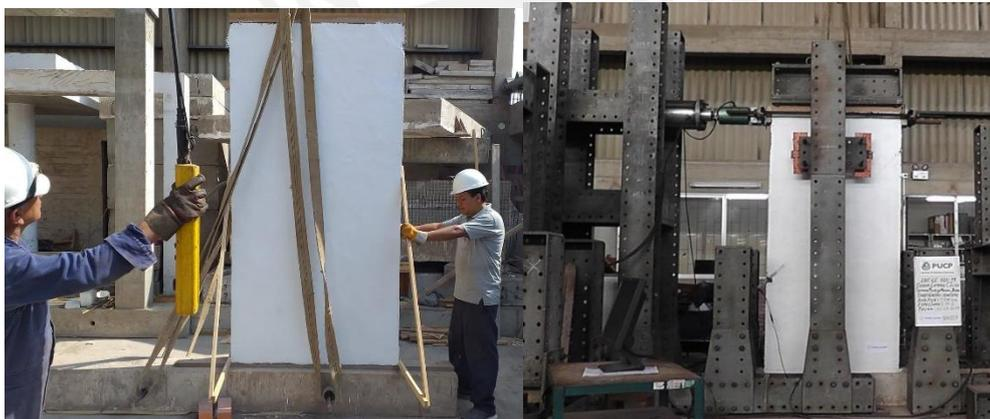
Figura 6.2: Izaje y colocación final previa al ensayo del espécimen.
