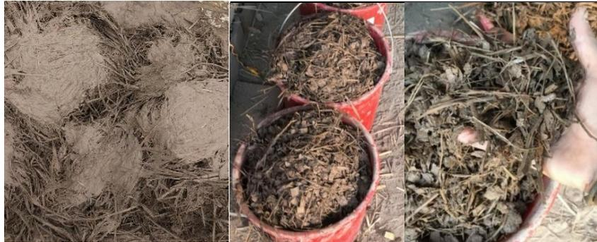
Figura 5.12: a) Mezcla con suficiente plasticidad. b) y c) Verificación de que las fibras estén totalmente recubiertas por la barbotina (Fotos propias)
