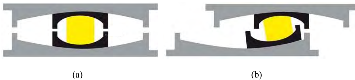
Figura 2.12: Sección transversal del aislador deslizante de péndulo triple en su (a) posición central y en su (b) posición desplazada [17]
