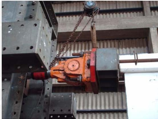
Fig. 7.8 Actuador Hidráulico
