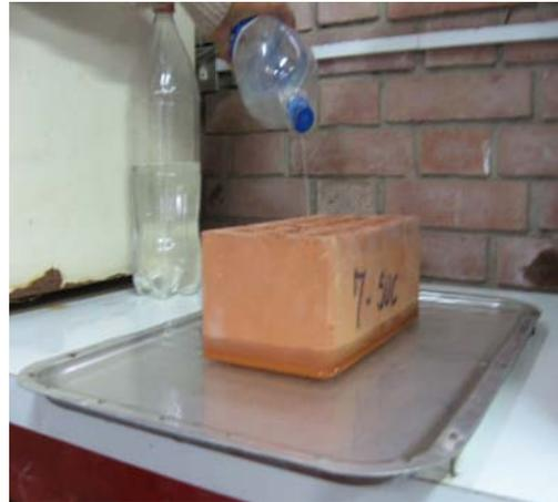
**Fig. 3.7** Desarrollo del ensayo de succión de los ladrillos
