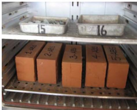
**Fig. 3.10** Secado de los ladrillos durante 24 horas
