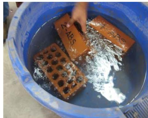
**Fig. 3.11** Reposo de ladrillos en agua fría durante 4 horas
