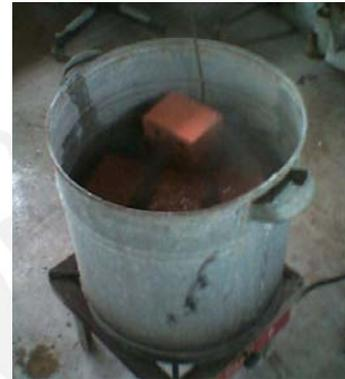
**Fig. 3.9** Reposo de ladrillos en agua hirviendo
