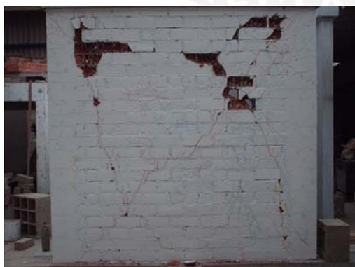
**Fig. 7.34** Estado final, Muro Tradicional
