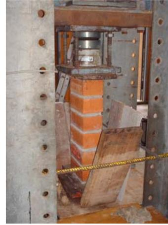
Fig. 4.3 Ensayo de Compresión Axial
