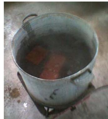
**Fig. 3.12** Ensayo de Absorción Máxima
