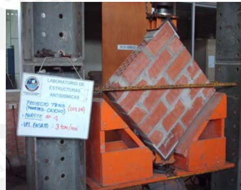
Fig. 4.9 Ensayo de Compresión Diagonal
