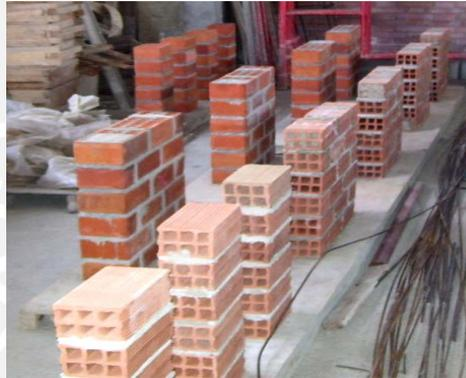
Fig. 4.1 Pilas y Muretes
