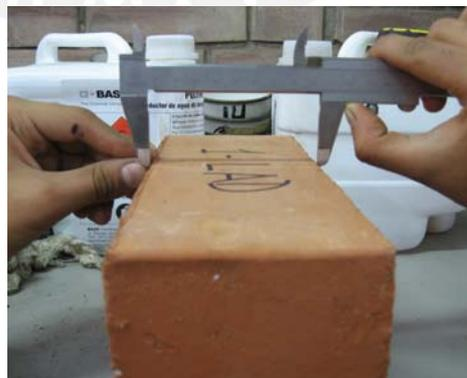
Fig. 3.4 Medición de ladrillos milimétricamente
