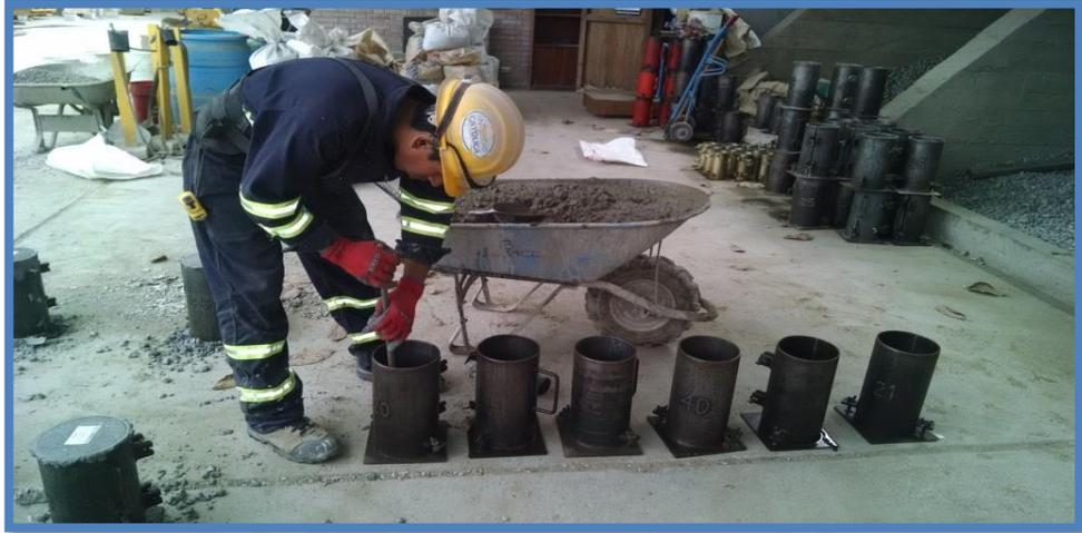
Fig. 4.9.- Obtención de Probetas cilíndricas de concreto.
