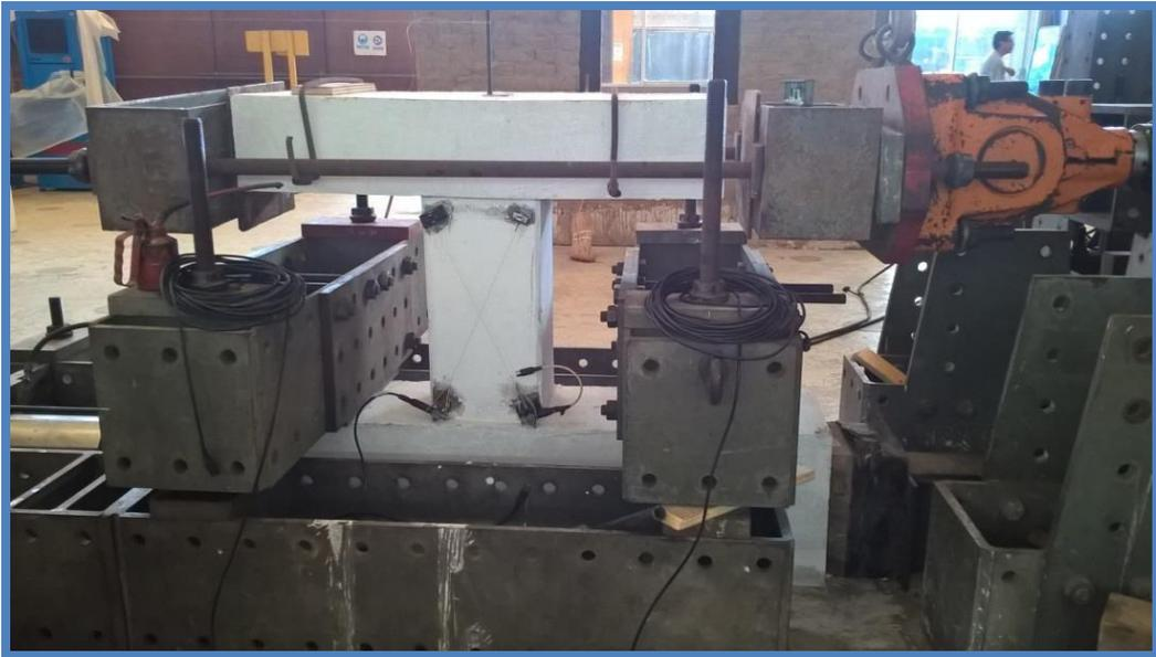
Fig. 5.3.-ensayo del espécimen sin refuerzo externo.
