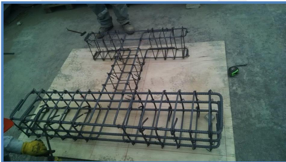
Fig. 4.5.- Ensamblado del espécimen.
