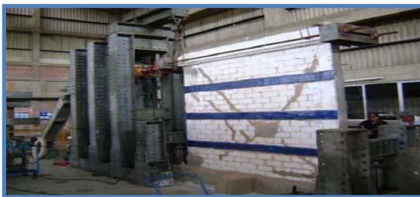
Fig. N° 2.4: Muro ensayado con bandas de CFRP. [3]
