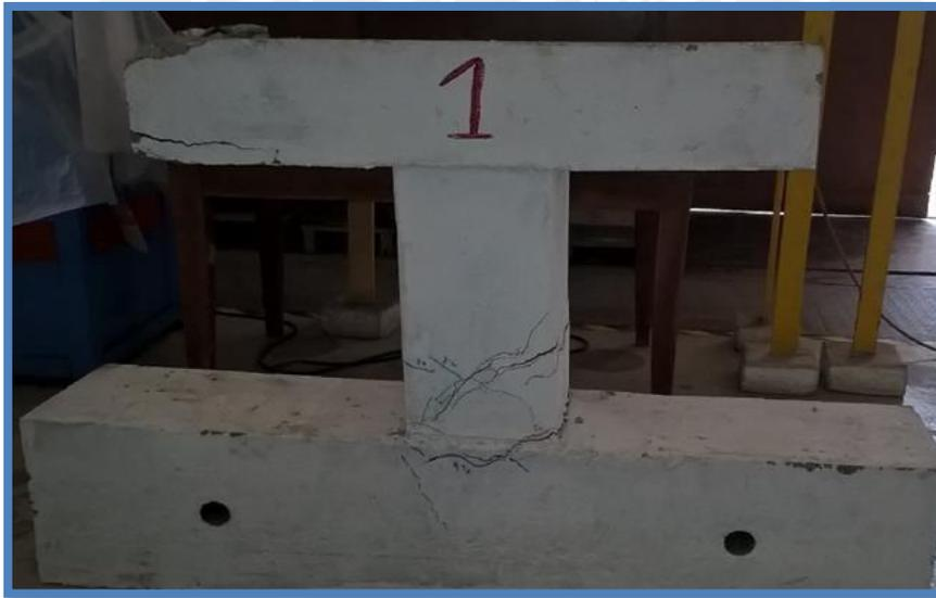
Fig. 5.13: Fisuras en el espécimen C1, después del ensayo.
