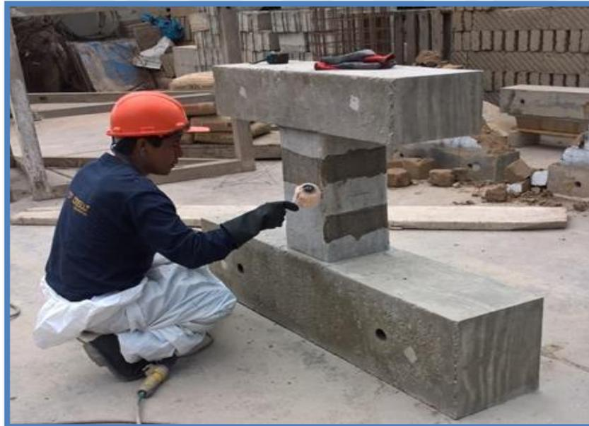
Fig. 4.13.-Aplicando la 1ra capa del epóxico tyfo.
