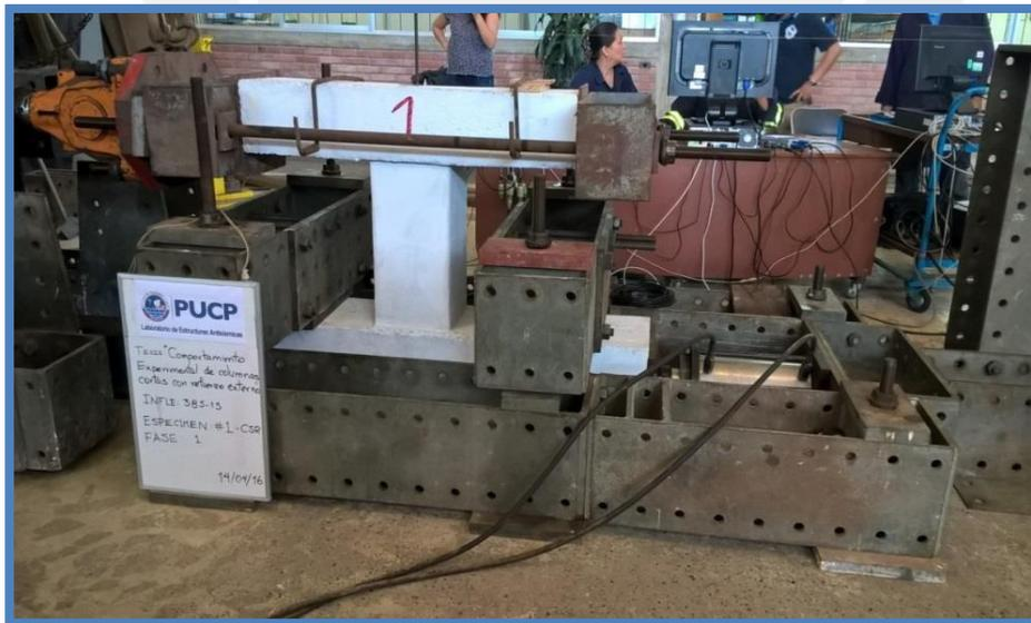
Fig. 5.5.- Ensayo de Carga Lateral Cíclica.
