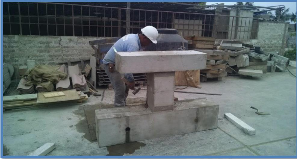
Fig. 4.11.- Desencofrado del espécimen de columna corta.
