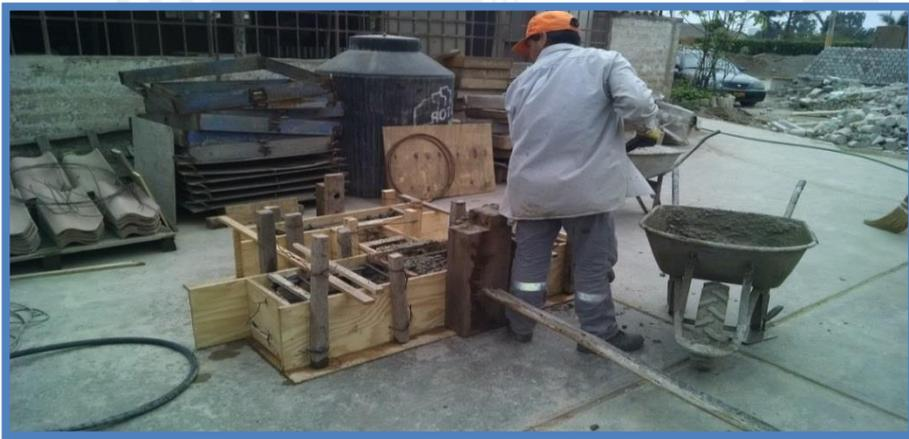
Fig. 4.8.- Vaciado del concreto en el espécimen.
