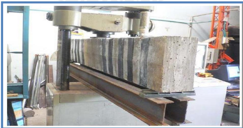
Fig. N° 2.6: Viga ensayada con refuerzo de CFRP. [4]
