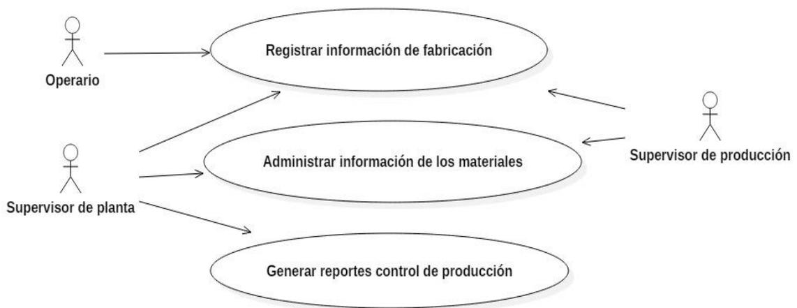
Figura 11. Diagrama de casos de uso para la aplicación de digitación y control. Fuente: Elaboración propia.
