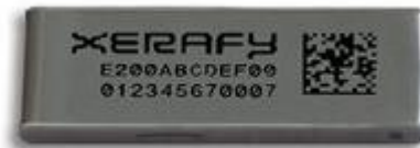
Figura 4.9 – Tag para metal Data Trak de Xerafy. [24]
