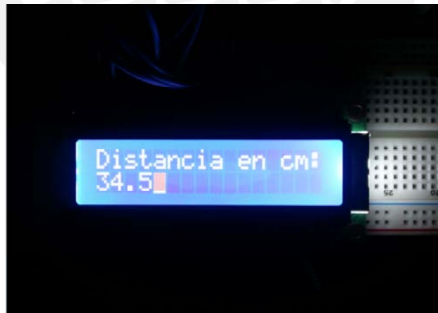
Figura 57: Distancia mostrada de 34.5 vs Distancia real de 34.2
