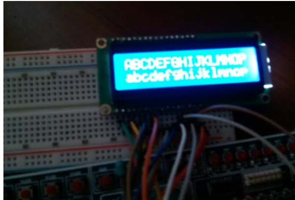
Figura 55: Prueba de funcionamiento del display LCD de 2x16
