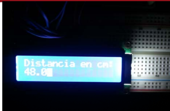
Figura 58: Distancia mostrada de 48.0 vs Distancia real de 48.4
