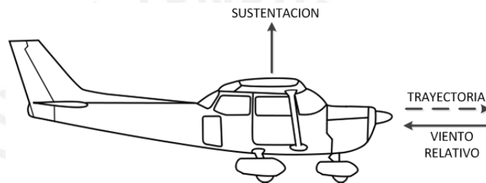
Figura 2.7. Fuerza de sustentación aplicada a una aeronave. Fuente: Elaboración propia. En base a [24].
