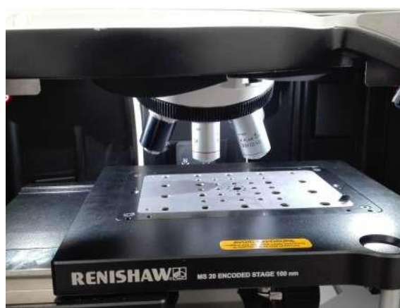
Figura 13. Espectrómetro Raman empleado en el análisis de microplásticos. (A) Vista completa del instrumento. (B) Vista de la plataforma motorizada donde se coloca la muestra para ser analizada.
