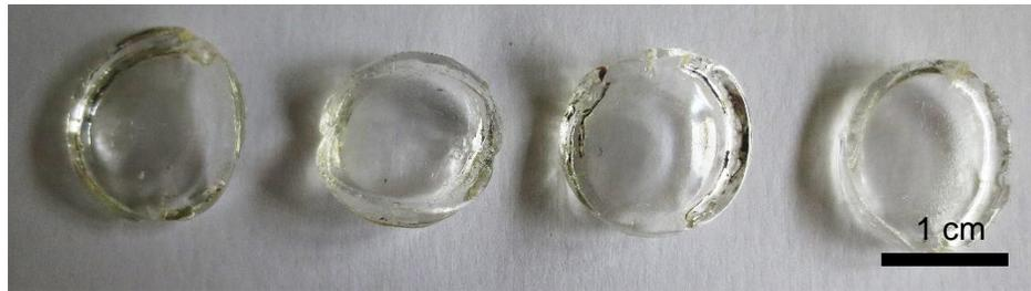
**Figura 19. Hidrogeles G1 secados en estufa a 50 °C.**
