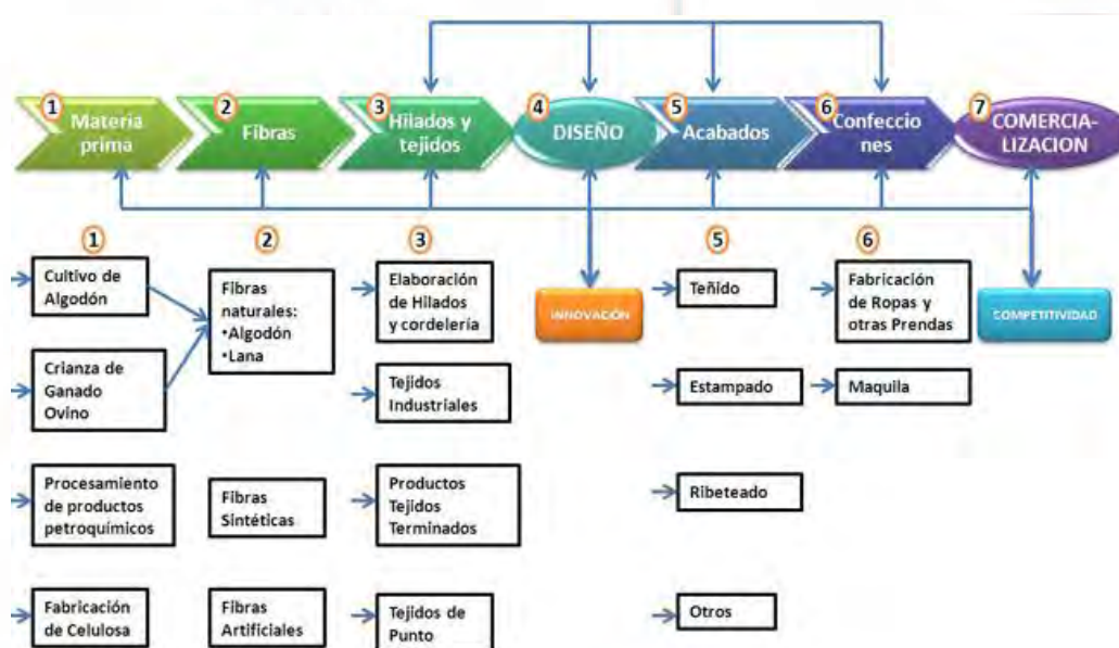
Figura 9. Proceso productivo de la industria textil Tomado de “Sistema de gestión para Empresas Textiles de producción y comercializadoras”. ConsultArg. Recuperado de: http://www.consultarg.com/erp_empresas_textiles.asp
