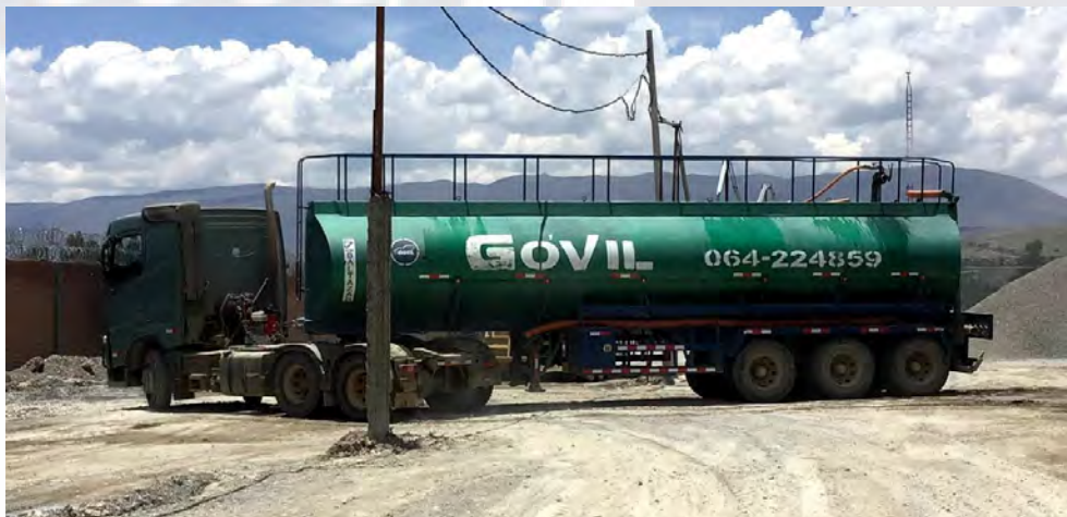
Figura 15. Camión cisterna para transporte de agua
