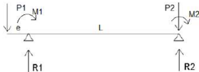
Figura 11.3.2 Modelo viga de cimentación
