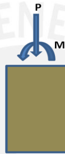
Figura 4.25. DCL del muro
