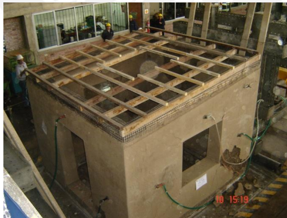
Figura 2.16. Ensayo dinámico de módulo de adobe con geomalla en laboratorio de Estructuras de la PUCP
