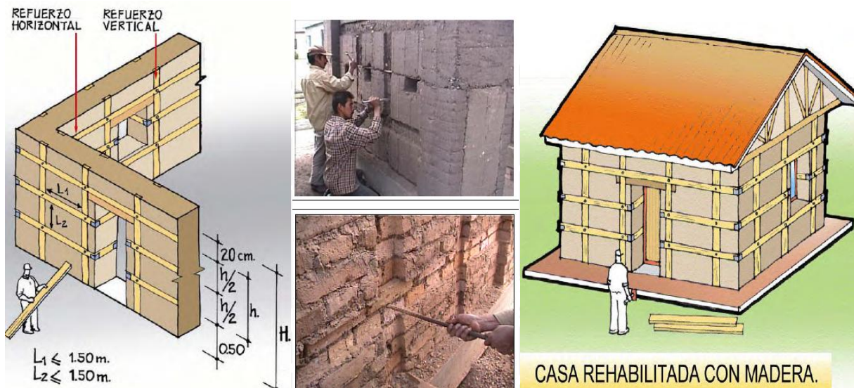
Figura 2.3. Rehabilitación con elementos de madera confinantes (AIS, 2010)
