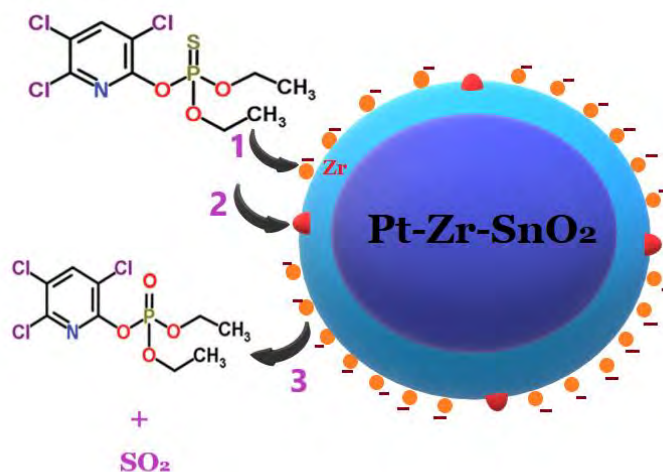
Figura 95. Esquema de la posible interacción del Clorpirifós con el sensor de Pt-Zr-SnO 2 . Las especies de oxígeno se representaron con esferas naranjas y la capa de agotamiento de electrones con la franja turquesa (exterior al círculo azul).
