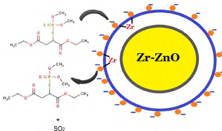
Figura 94. Esquema de la posible interacción del Malatión con el sensor de AT-Zr-ZnO. Las especies de oxígeno se representaron con esferas naranjas y la capa de agotamiento de electrones con la franja blanca (entre el círculo azul y negro).
