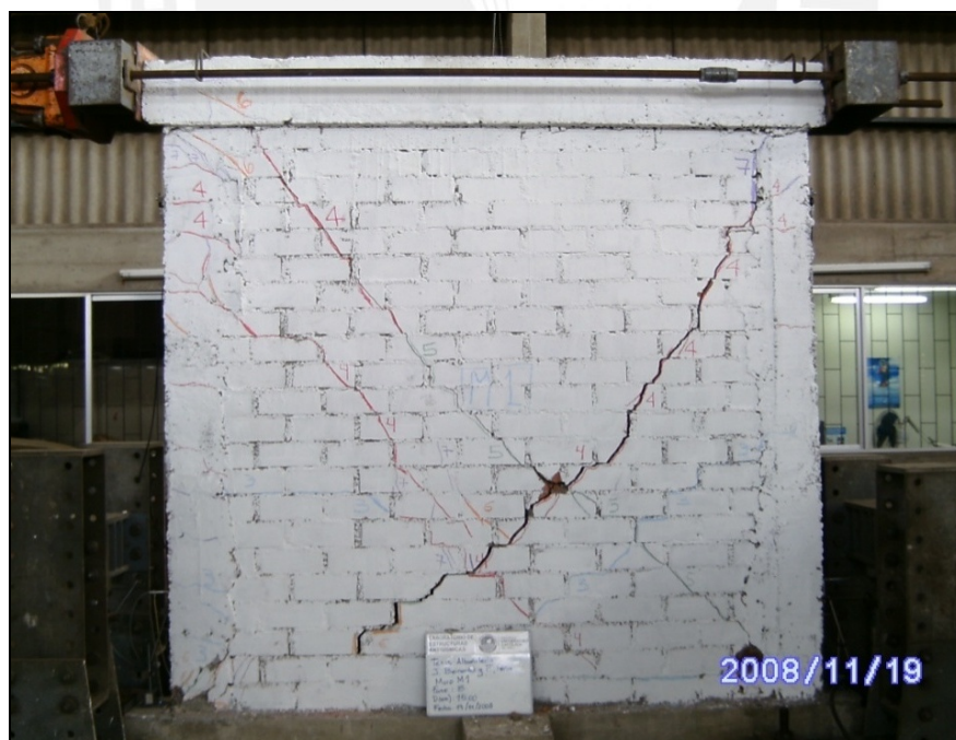
Fig. 7.11 Estado del Muro M1 al final del ensayo.
