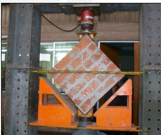
Fig. 4.6 Vista Global de los dispositivos de ensayo a compresión diagonal.
