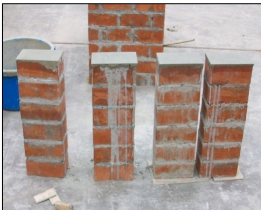
Fig. 4.2 Pilas de albañilería con el capping ya colocado.
