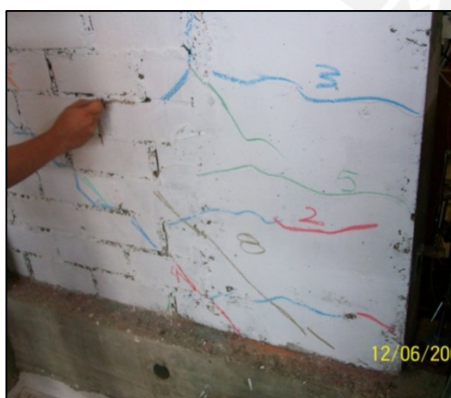
Fig. 7.19 Fisuras producidas en la fase 8 del ensayo de M2.
