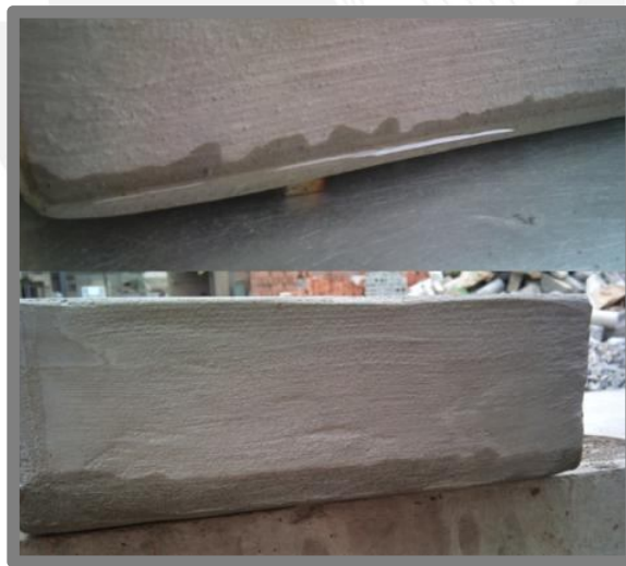
Fig. 28 Capilaridad en la muestra de adobe tarrajado producto del ensayo de succión.
