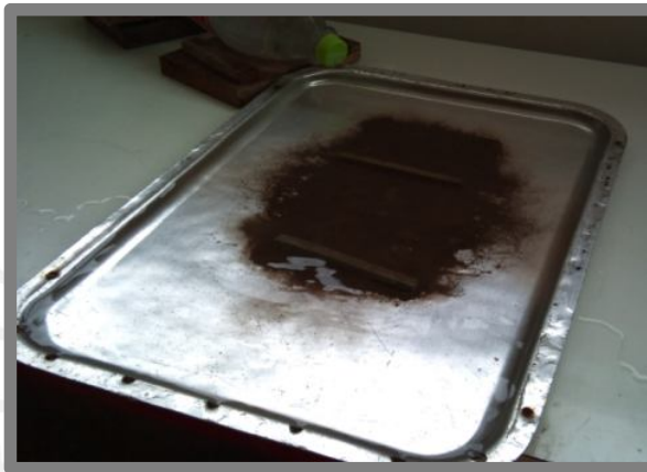
Fig. 25: Perdida de material del adobe que descalifica los resultados obtenidos.
