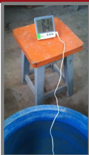
Fig. 20: Registro de la temperatura del agua para el ensayo de absorción.
