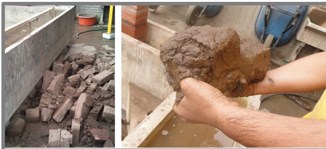
Fig. 36: Muro patrón derrumbado, consistencia del material estancado.
