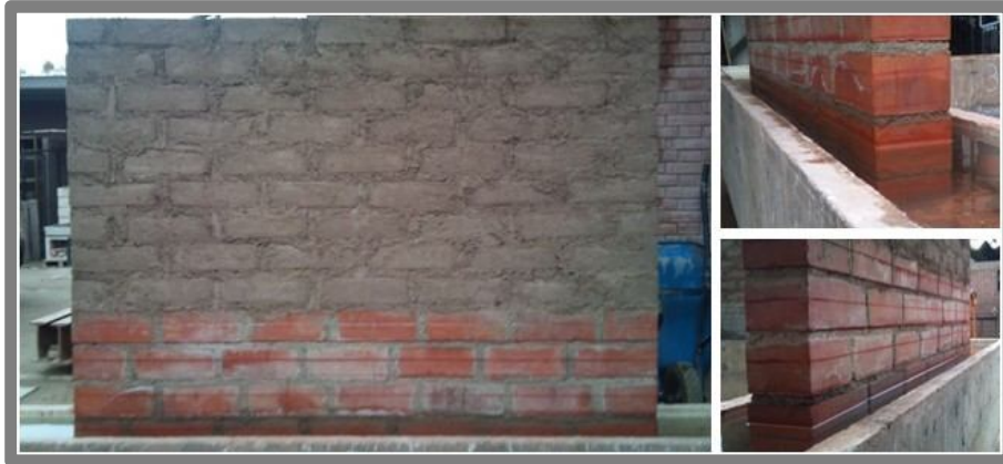
Fig. 37: Ensayo del muro con sobrecimiento de ladrillos ML. Día 19.
