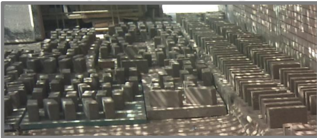
Fig. 1: Fabricación de unidades de adobe
