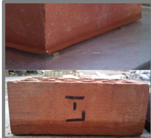
Fig. 26: Capilaridad en la muestra de ladrillo producto del ensayo de succión.
