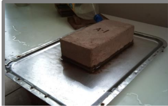
Fig. 24: Prueba de Succión en adobes del muro MP
