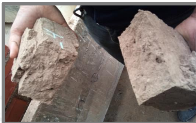
Fig. 59: Corte de un adobe en el que se aprecia la ausencia de paja.
