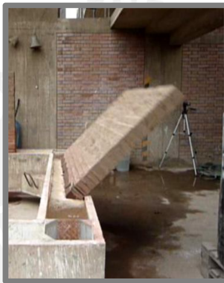
Fig. 35: Falla del Muro Patrón ante el ensayo de inundación.
