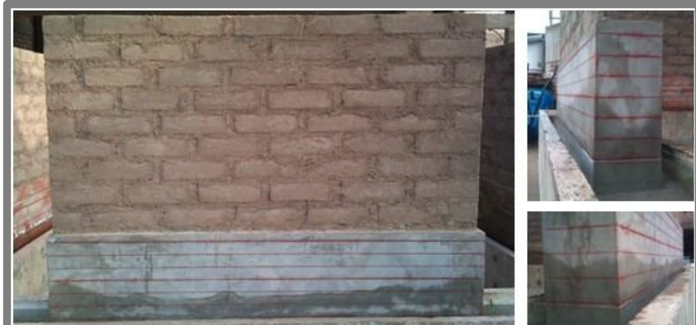
Fig. 40: Ensayo de inundación del muro tarrajado MT (Izq. & Der. Inferior - Día 8, Der superior – Día 12)
