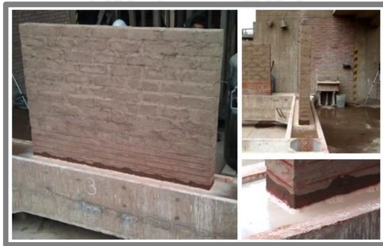
Fig. 34: Ensayo de inundación del Muro Patrón (MP)
