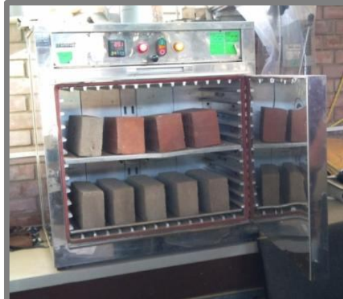
Fig. 17: Secado de las muestras en horno a 110°C
