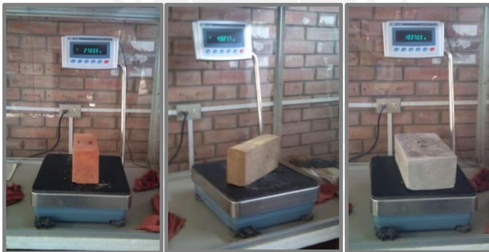
Fig. 18: Registro del peso seco de los especímenes representativos de cada alternativa.
