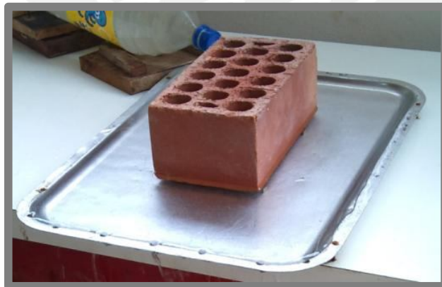
Fig. 27: Ensayo de succión de la muestra de ladrillo.
