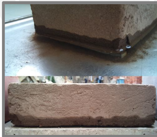
Fig. 23: Capilaridad en adobe MP producto del ensayo de succión.
