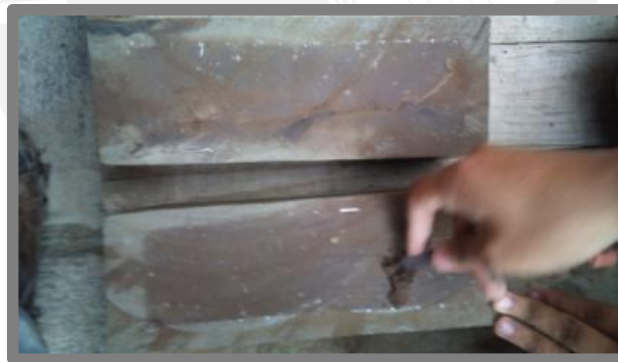
Fig. 33: Vista del corte de una muestra de adobe tarrajado luego de 24 horas de inmersión.
