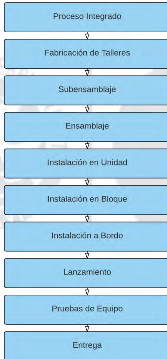
Figura 67. Proceso de fabricaciones navales. Tomado de “Lineamientos estratégicos para la construcciones navales de alto bordo en el Perú,” por Benzaquen et al., 2010, p. 27, México D. F., México: Pearson.
