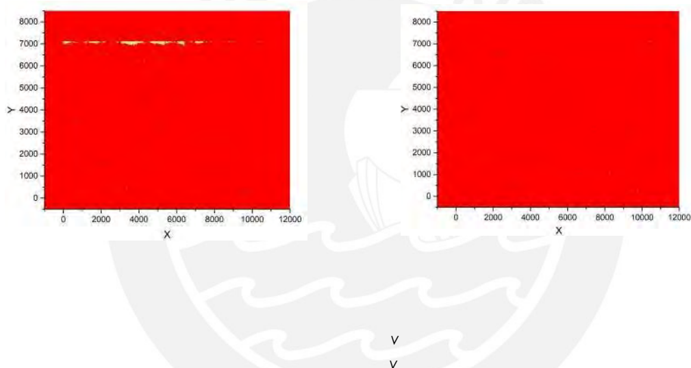
Fig. 5.14 Distribución no uniforme de un SSNTD (Elaboración propia) a) Detector con \rho = 403 \text{ Trcm}^{-2} , \chi^2_{\nu} = 3,28 ; b) Detector con \rho = 314 \text{ Trcm}^{-2} , \chi^2_{\nu} = 1,13
