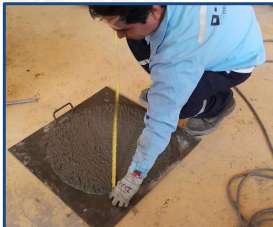
Imagen 7: Medición del Slump
