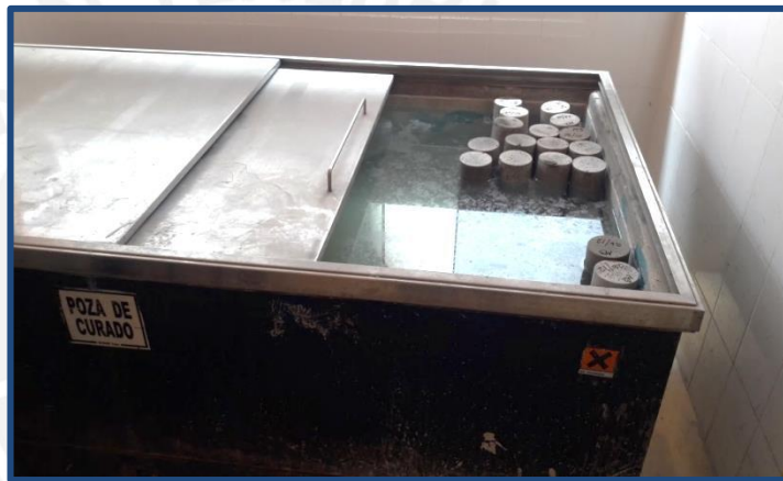
Imagen 18: Curado de probetas
