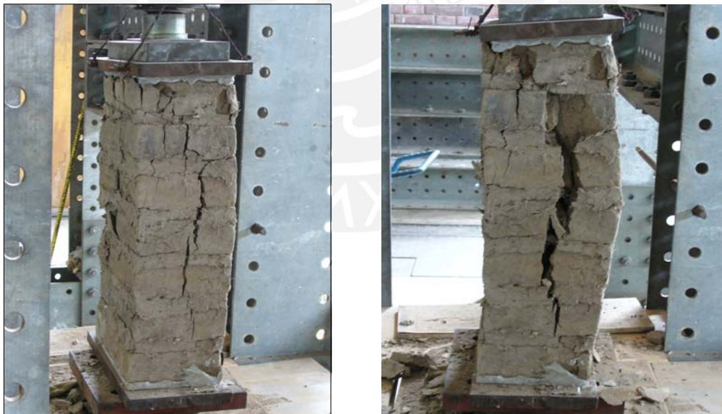
Fig. 4.12 Falla de la Pila 3
