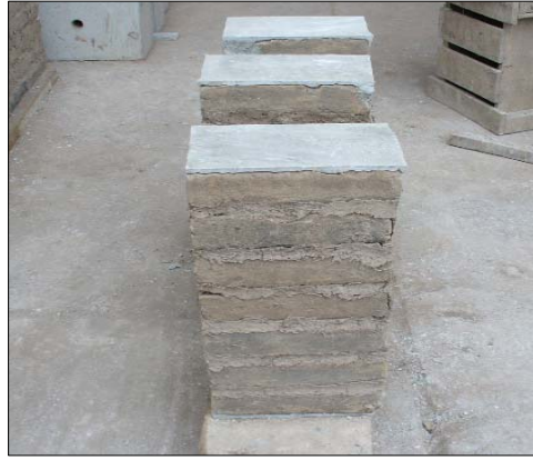
Fig. 4.7 Tres de las Pilas con el capping ya colocado
