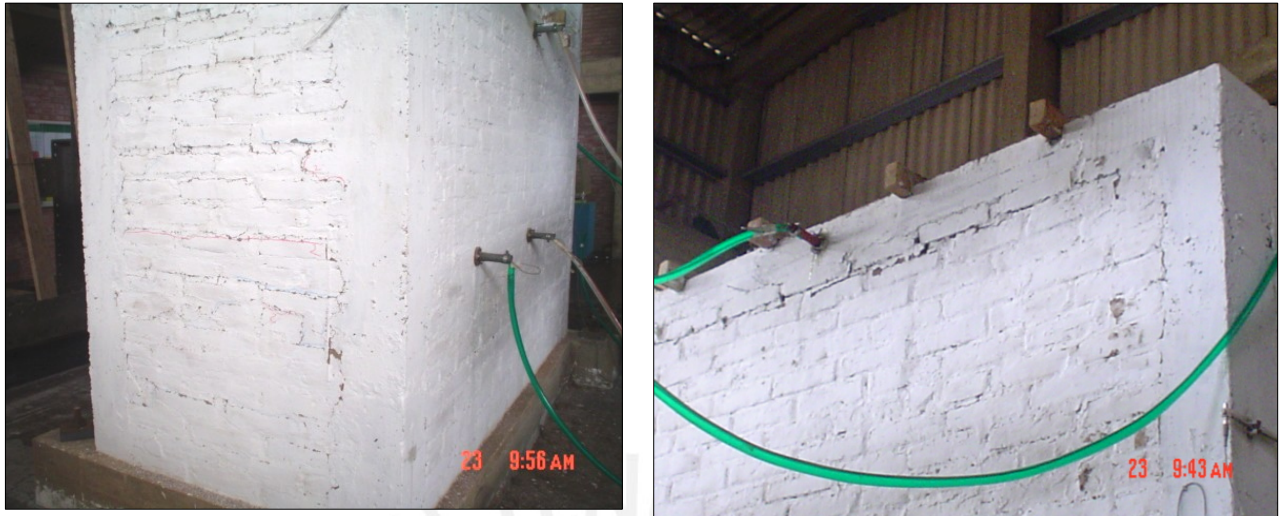
Fig. 6.6 Ensayo sísmico Fase 1
