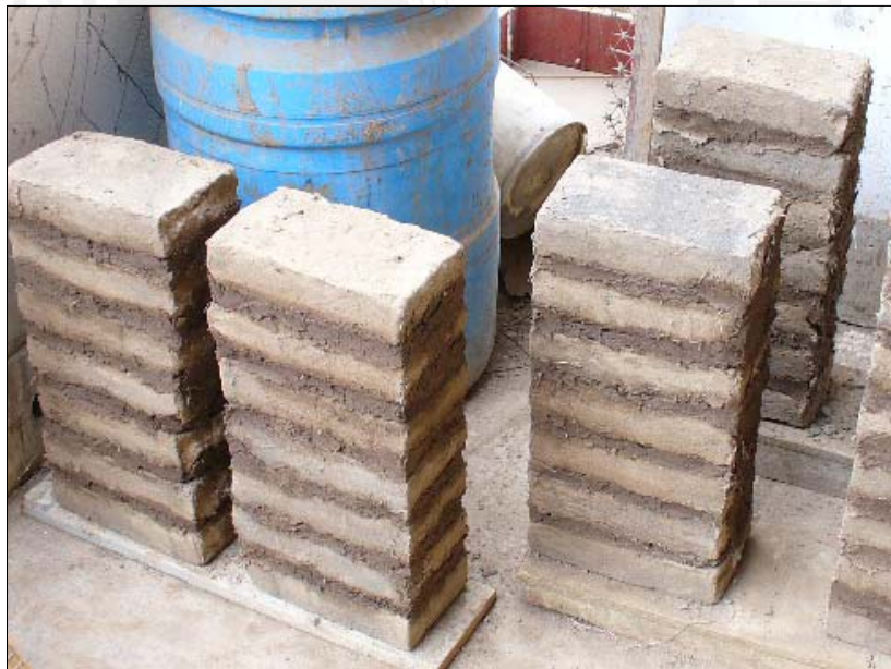
Fig. 4.6 Pilas de adobe aún frescas luego de su construcción.
