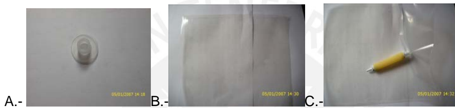
Figura 16.- Partes y sachet ensamblado: A.- pitón en resina EVA, B.- sachet bilaminado, C.- sachet empitonado y manguera completamente ensamblada insertada.
