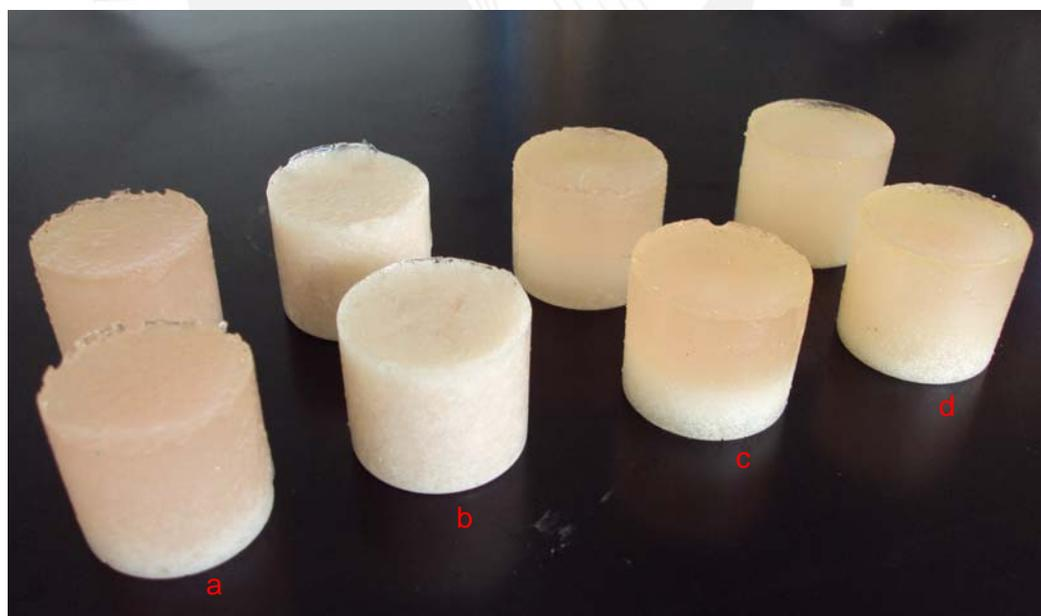
**Figura 79.** Probetas elaboradas con a. EHD-AM, b. EHD-AM-BHET, c. EHD-AM-AA y d. EHD-AM-BHET-AA y 50% de NaCl.
